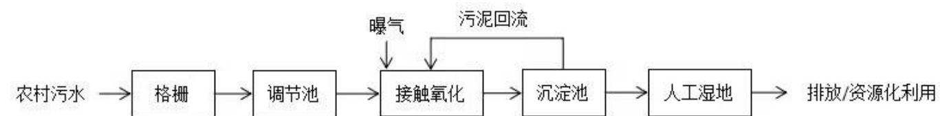
图 4.4-7 接触氧化+人工湿地工艺流程图
